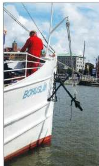
Ankaret bänger i säkringsrepet och ginan. Ginan släcks och tas hem. Repet lossas och ankaret går. Foto Bo Starmark 8 augusti 2011
