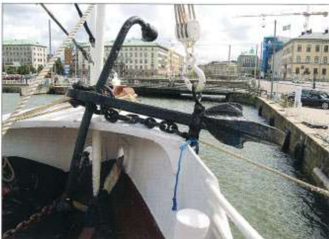
Ankaret ligger på svintryggen. Kattginans krok är fast vid ringen. Säkringsrepet ryms för om ankaret. Foto Bo Starmark 8 augusti 2011
